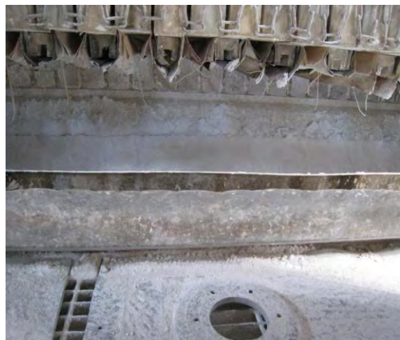
照片 4：在製造三鹽基性硫酸鉛汙泥餅機具的下方，陳年的含鉛安定劑灰塵堆積。
