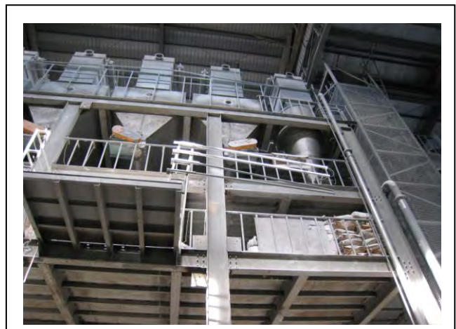
上二圖為混和包裝倉庫的機具，左圖為傾倒安定劑單方之處，傾倒後經右圖空氣輸送壓縮進行混和。
