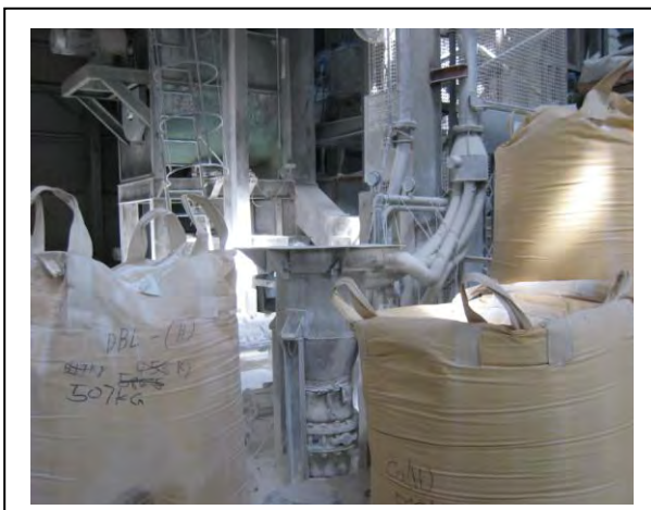
上二圖為混和包裝倉庫的機具，左圖為傾倒安定劑單方之處，傾倒後經右圖空氣輸送壓縮進行混和。
